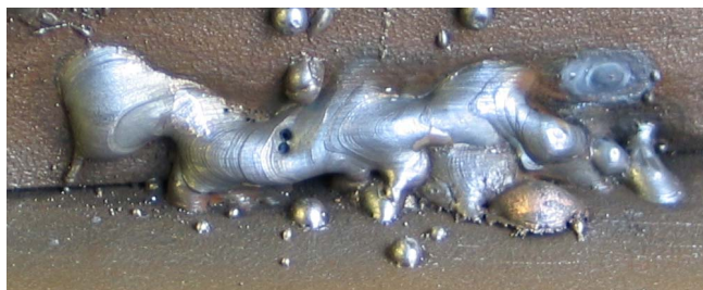
b). Early Fillet Weld.
